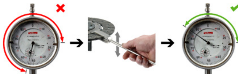
Zdjęcie 1 – Przyrząd do pomiaru bicia bocznego sprzęgła
