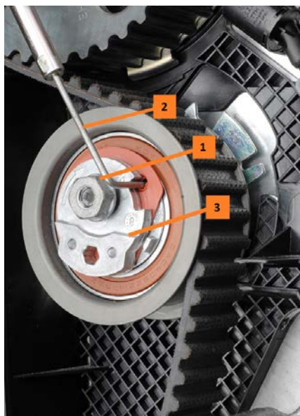
Rys. 8 - Układ napinacza paska rozrządu: nakrętka rolki napinającej [1], trzpień blokujący rolkę napinającą T 10265 [2], mimośród rolki napinającej [3]
