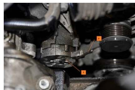
Rys. 3 - Zablokowanie napinacza paska wielorowkowego [1] za pomocą narzędzia nr T 10060 [2]
