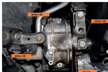
Rys. 16. Momenty dokręcenia śrub prawej poduszki silnika oraz maksymalny odstęp od wspornika prawej poduszki silnika
