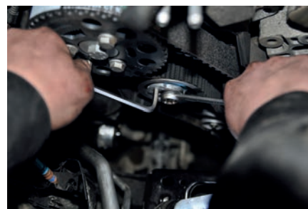
Rys. 12. Sposób regulacji rolki napinającej.
