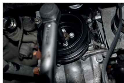
Rys. 17. Prawidłowy montaż koła pasowego paska wielorolkowego. Moment dokręcenia śrub: 10 Nm + 90°
