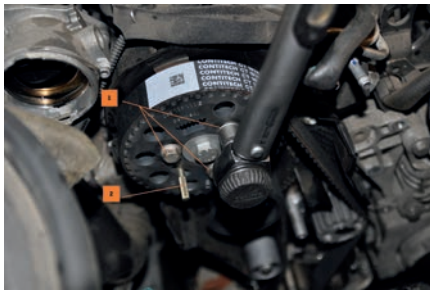
Rys. 14. Prawidłowy sposób dokręcania śrub koła zębatego wałka rozrządu [1]. Moment dokręcenia: 20 Nm + 45°. Kołek blokujący – [2]
