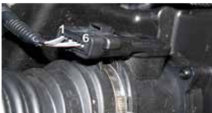
Przykład przypisania pinów czujnika MAF: pin 1 – sygnał czujnika temperatury – powietrze dolotowe, pin 2 – masa, pin 4 – zasilanie +12 V, pin 5 – sygnał masy powietrza.
