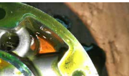
Przykład metalicznych wtrąceń w oleju sprężarkowym, który kwalifikuje układ do płukania.
