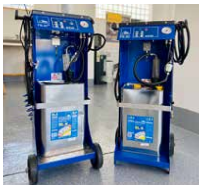
Zdj. 4 Zalecane przez producenta systemów hamulcowych firmę ATE urządzenia do wymiany płynu hamulcowego: ATE FB30, FB30SR.
