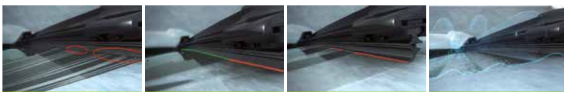
Pęknięte ostrze pióra
