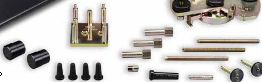
Fot. 4 Narzędzie specjalne do ustawiania pierścienia w DKZ oraz montażu sprzęgła 2CT w Skrzyniach C635 znanych jako TCT, DDCT.
