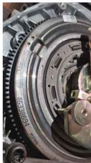
Fot. 5 Montaż podstawy i przyrządu na DKZ oraz zablokowanie zapadek w łuzach.
