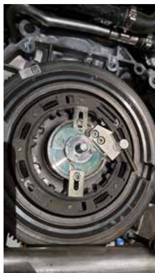
Fot. 4 Narzędzie specjalne do ustawiania pierścienia w DKZ oraz montażu sprzęgła 2CT w Skrzyniach C635 znanych jako TCT, DDCT.
