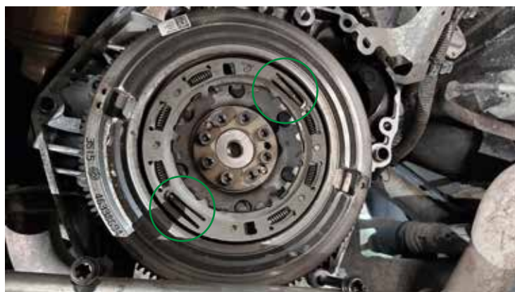
Fot. 6 DKZ w ustawieniu gotowym do montażu skrzyni biegów.
