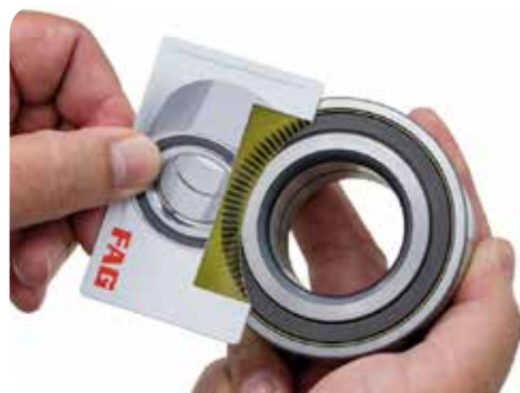
Foto 1: Karta detekcyjna służy do wykrycia strony montażu enkodera aktywnego. Nie zadziała w przypadku enkodera pasywnego.
