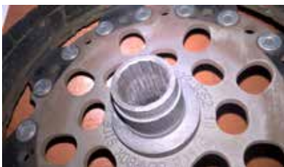
fot. 1: Uszkodzenie wieloklinu tarczy sprzęgłowej.
