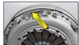
Foto 1: Otarcia powierzchni wieloklinu zastosowania zbyt długiej śruby
