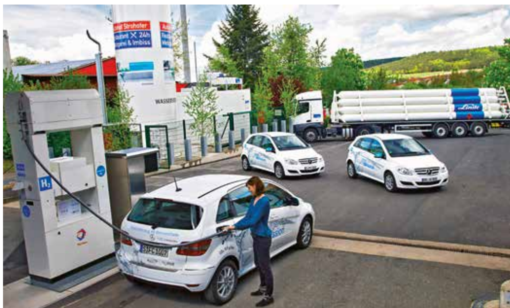
Tankowanie wodoru na jednej ze stacji autostradowych w Niemczech. Napełnienie zbiorników wodorem zajmuje zwykle od 3 do 5 minut.
