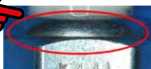
Podrobiony produkt ze śladami obróbki maszynowej w miejscu obciśnięcia.
