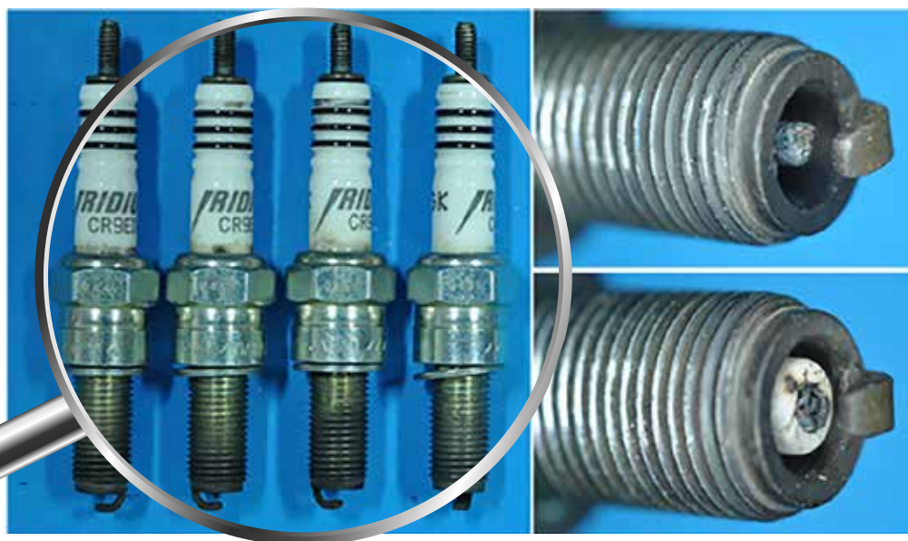
Przykłady stopionej elektrody centralnej na podrabionych świecach zapłonowych CR9EIX.
