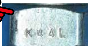
Podrobiony produkt ze śladami obróbki maszynowej w miejscu obciśnięcia.
