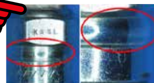
Ślady obróbki maszynowej po cięciu na powierzchni wyżłobienia pierścieniowego (produkt podróbiony).
