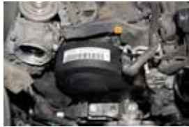
Rys. 2. Górna osłona paska rozrządu [1].
