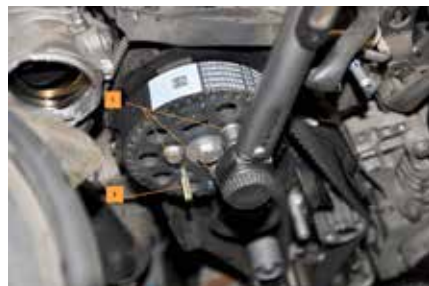
Rys. 14. Prawidłowy sposób dokręcenia śrub koła zębatego wałka rozrządu [1]. Moment dokręcenia: 20 Nm. + 45°. Kołek blokujący – [2].
