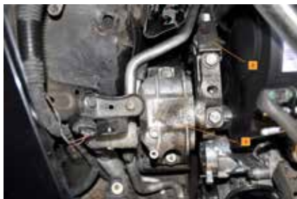
Rys. 4. Prawa poduszka silnika [1] i wspornik prawej poduszki silnika [2].
