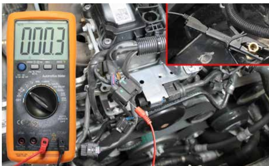
Ilustracja 6 – Pomiar rezystancji świec żarowych z modułu świec żarowych (złącze odłączone). 0,3 oma w temperaturze 23°C. MERCEDES-BENZ C180 CDI (W204), kod silnika 651.913.
