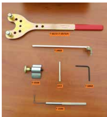
Rys. 1. Narzędzia specjalne niezbędne do wykonania wymiany rozrządu w silniku BXE.
