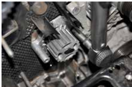
Rys. 10. Prawidłowy sposób dokręcenia śrub mocujących pompę wody. Moment dokręcenia: 13 Nm.
