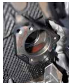
Rys. 9. Miejsce osadzenia pompy wody w bloku.
