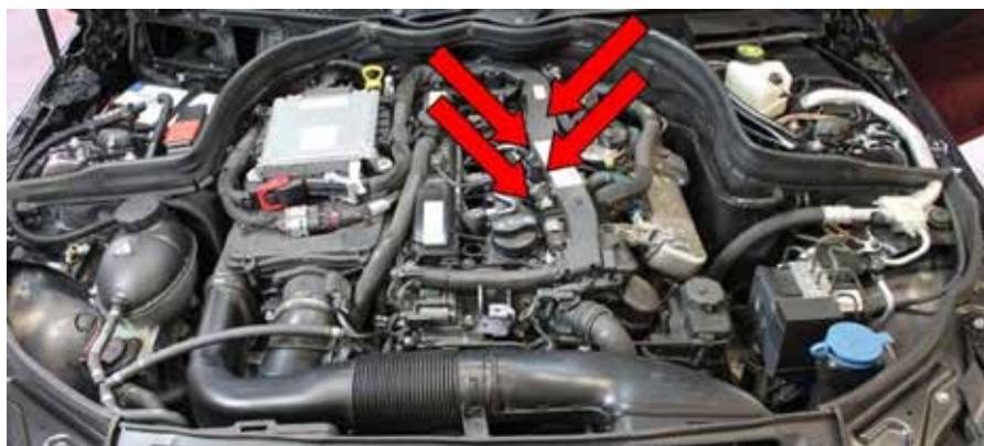
Ilustracja 2 – MERCEDES-BENZ C180 CDI (W204), kod silnika 651.913, przedział silnika i pozycje montażowe świec żarowych.
