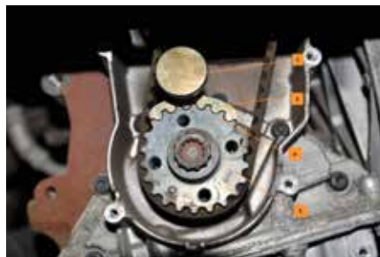
Rys. 7. Ustawienie blokady nr T 10100 [1] na kole zębatym rozrządu [2] oraz ustawienie wzajemnie znaczników blokady [3] i koła zębatego [4].
