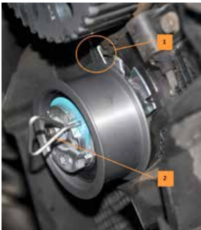
Rys. 11. Położenie rolki napinającej przed montażem paska rozrządu: [1] – występ płyty podstawy rolki, [2] – trzpień blokujący położenie rolki.
