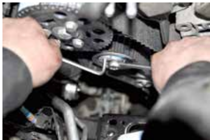
Rys. 12. Sposób regulacji rolki napinającej.
