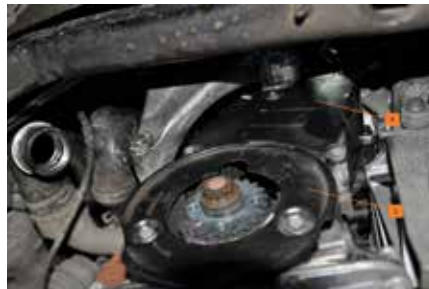
Rys. 5. Osłony paska rozrządu: dolna [1] i środkowa [2].
