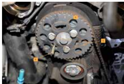
Rys. 6. Położenie znacznika na kole zębatym wałka rozrządu [1] przy GMP wału korbowego oraz sposób zablokowania wałka rozrządu za pomocą narzędzia nr 3359 [2]. Śruby koła zębatego wałka rozrządu – [3].
