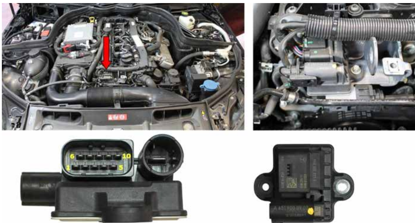
Ilustracja 5 – Położenie montażowe modułu świec żarowych oraz jego detale i styk wyjściowy. MERCEDES-BENZ C180 CDI (W204), kod silnika 651.913.
