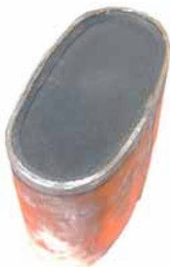
Ilustracja 1 – przykład zablokowanego filtra DPF w AUDI A3 2.0 TDI (model 8P).
