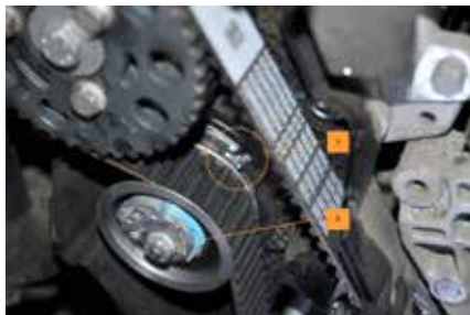
Rys. 13. Prawidłowe ustawienie rolki napinającej [1]. Moment dokręcenia nakrętki: 20 Nm. + 45°.
